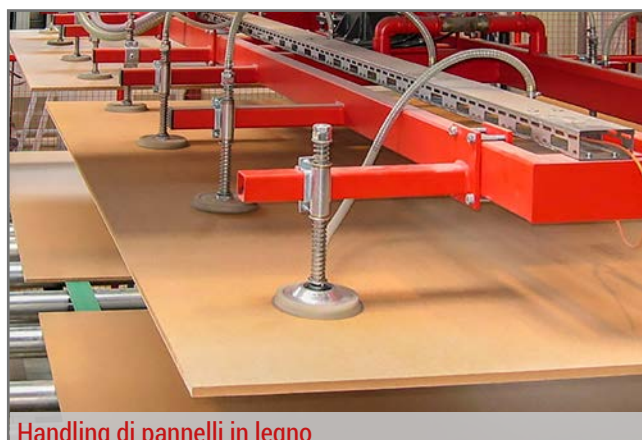
Handling automatizzato di pannelli in legno con telaio a ventose
