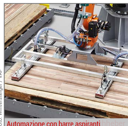
Sistema di carico per pannelli di lamiera
