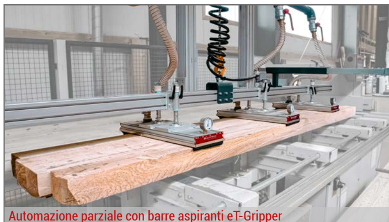
Barre aspiranti eT-Gripper in impianto automatizzato
