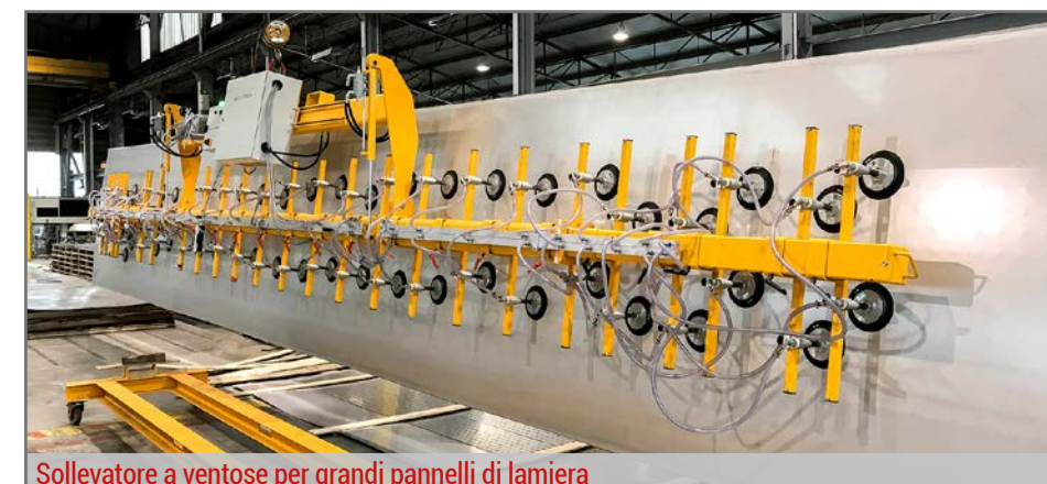
Dispositivo di sollevamento per lastre di vetro estremamente grandi
