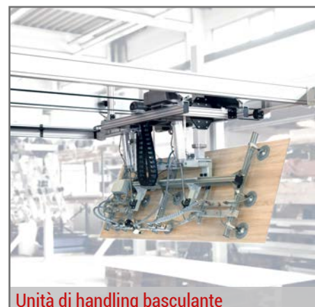
Barre aspiranti eT-Gripper in impianto automatizzato
