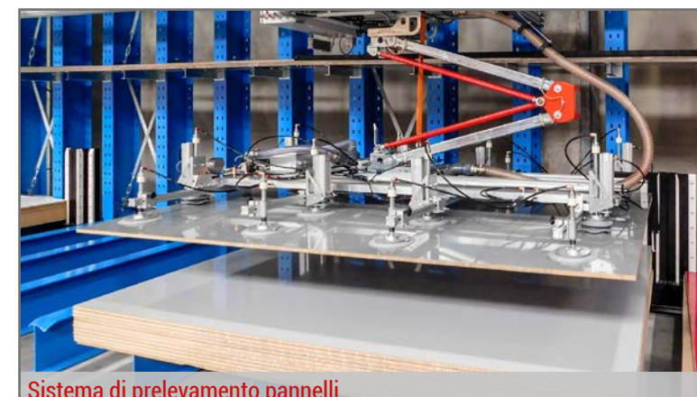
Con le barre aspiranti anche il legno molto strutturato, inclusa la segatura, non è un problema
