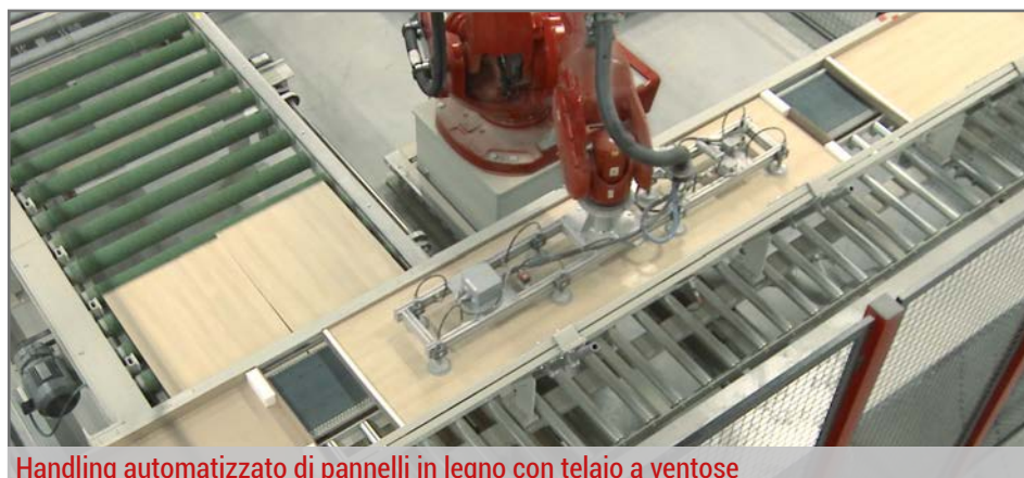
Automazione parziale con barre aspiranti eT-Gripper
