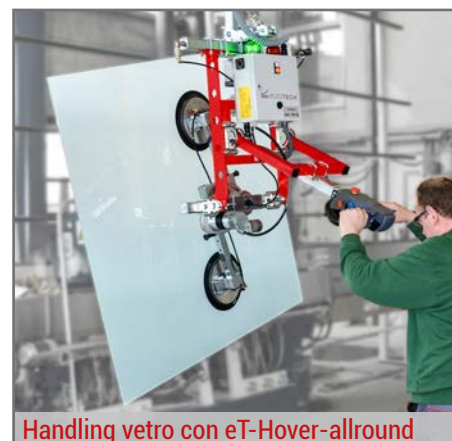
Dispositivo di sollevamento per l'industria del vetro
